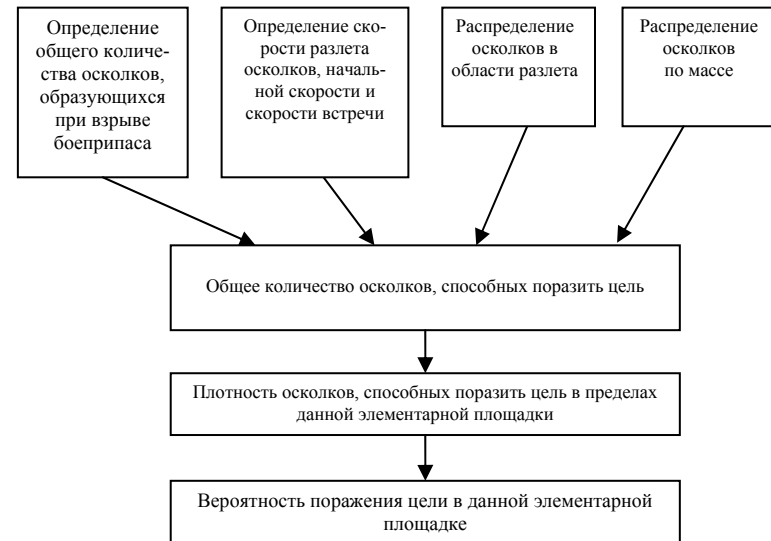
Рис. 7. Определение средней вероятности поражения рассматриваемой цели для конкретной элементарной площадки
